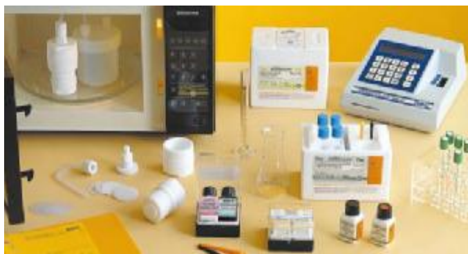
Kompletní rozkladné pracoviště s mikrovlnnou jednotkou
